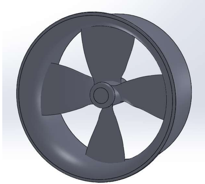
Figura 32 - Montagem do conjunto da hélice e bosso junto ao duto 19A
